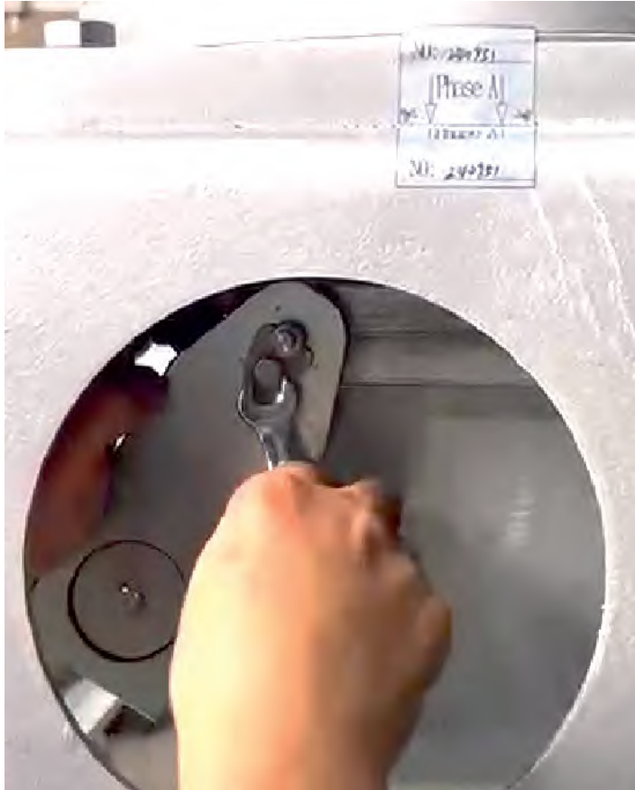
Малюнок 25 - з'єднувальна вісь тяги та механізму в робочому положенні
